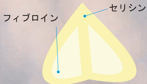
図：シルクの構造（断面）
